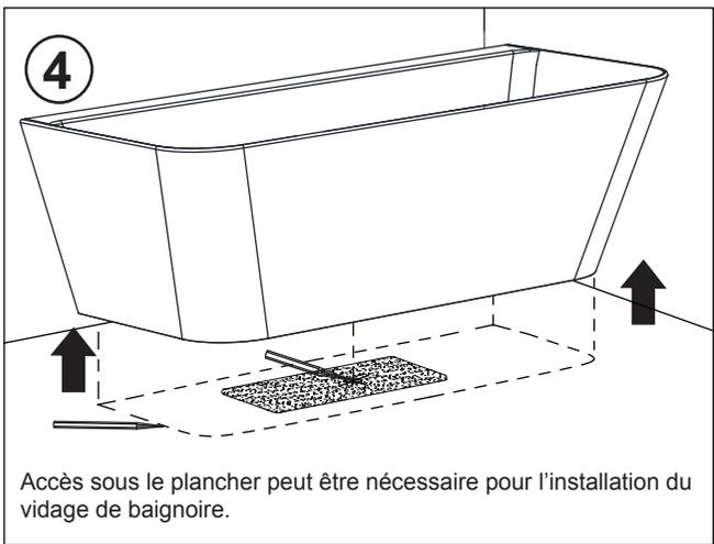
Accès sous le plancher peut être nécessaire pour l'installation du vidage de baignoire.
