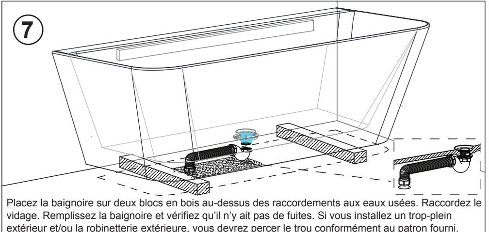
Placez la baignoire sur deux blocs en bois au-dessus des raccordements aux eaux usées. Raccordez le vidage. Remplissez la baignoire et vérifiez qu'il n'y ait pas de fuites. Si vous installez un trop-plein extérieur et/ou la robinetterie extérieure, vous devrez percer le trou conformément au patron fourni.
